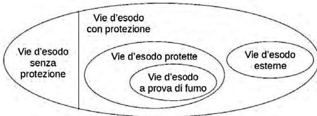
ILLUSTRAZIONE S.4-1: CLASSIFICAZIONE DELLE VIE D'ESODO IN FUNZIONE DELLA PROTEZIONE DALL'INCENDIO
