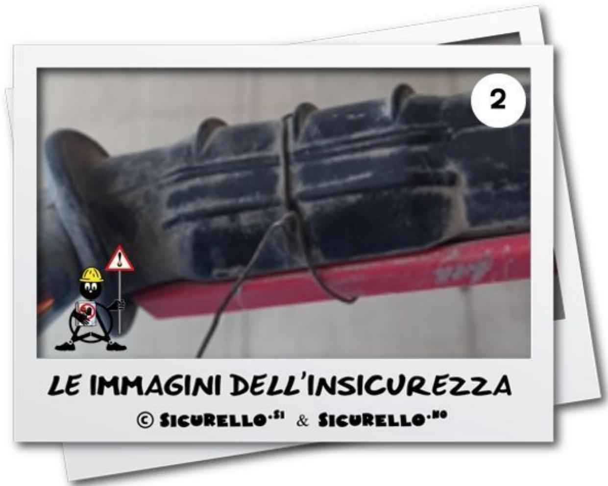
L'aneddoto legato a questa immagine è anch'esso classico: una volta rilevata, l'alterazione del dispositivo viene segnalata al preposto, che va dal lavoratore (si trattava di un addetto all'utilizzo della lisciatrice per caldane ? il cosiddetto "elicottero") che lo guarda, ti guarda e poi precisa che lui non centra nulla, che l'attrezzatura l'ha trovata così e così la sta utilizzando, che non lo sapeva, che adesso lo sa, che....
