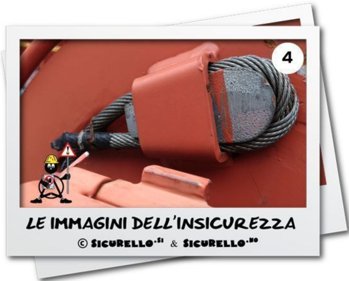
Nel primo caso la "testata" della corda è stata fatta con filo di ferro, nel secondo utilizzando esclusivamente un morsetto.
