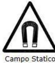
**Figura 1-a** Segnaletica di sicurezza presenza rischio campi elettromagnetici
