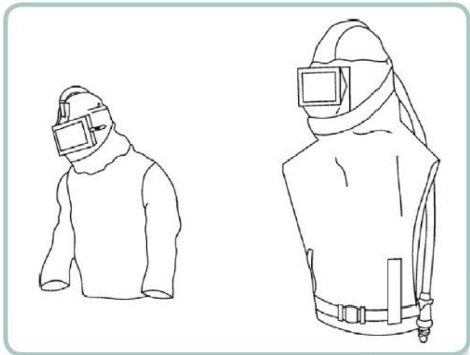
Figura 2: esempio d'indumento di protezione di Tipo 3 per operazioni di sabbiatura
