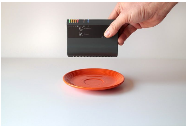
(Foto: identificazione di una sorgente radioattiva pericolosa apparentemente innocua)
