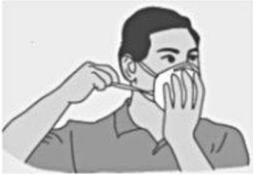
2) Portare il respiratore al mento con lo stringinaso verso l'alto; quindi portare il passante superiore dietro il capo e posizionarlo al di sopra delle orecchie. Nello stesso modo posizionare il passante inferiore al di sotto delle orecchie, attorno al collo.
