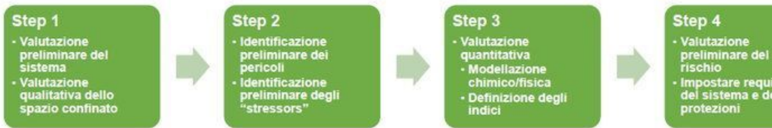
Figura 1. Diagramma di flusso della metodologia finalizzata alla valutazione quantitativa dei pericoli associati alle operazioni in spazi confinati.
