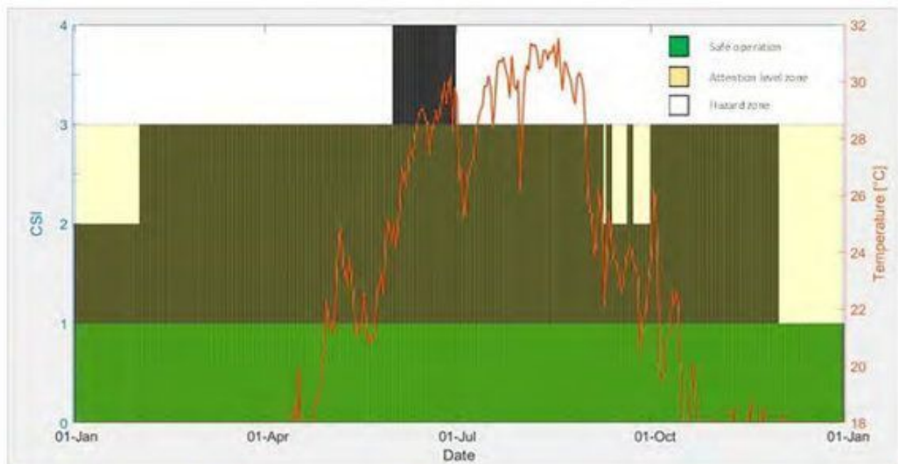
Figura 3. Valutazione CSI (linee scure dell'istogramma) e classificazione dei rischi per il caso di studio (vedi sfondo ombreggiato). Viene inoltre riportato l'andamento della temperatura ipotizzato per l'anno di esercizio (vedi linea continua).
