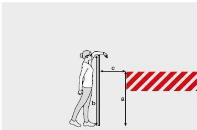
Distanze di sicurezza relative all'accesso oltre strutture di protezione (ad es. recinzioni protettive)
