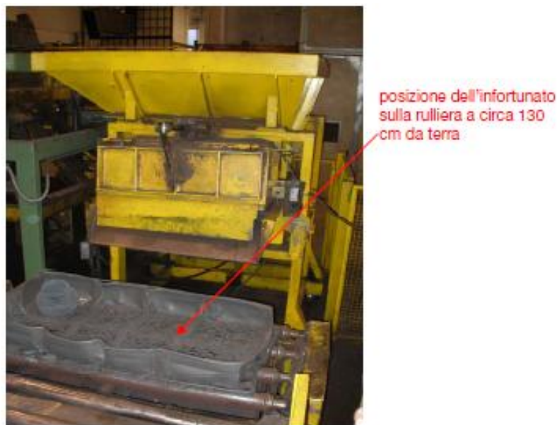
Tramoggia di carico con portello pneumatico aperto e pezzi in lavorazione
