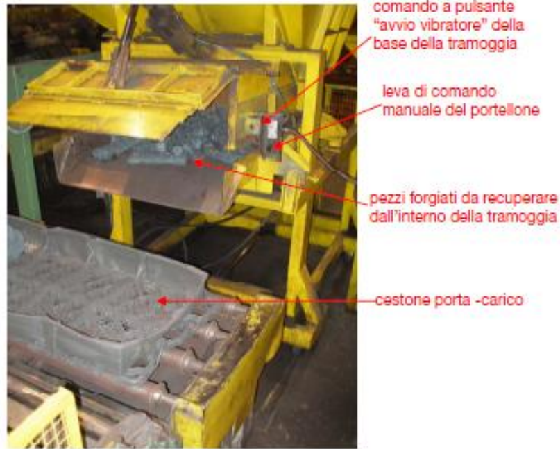
Tramoggia di carico con portello pneumatico aperto e pezzi in lavorazione
