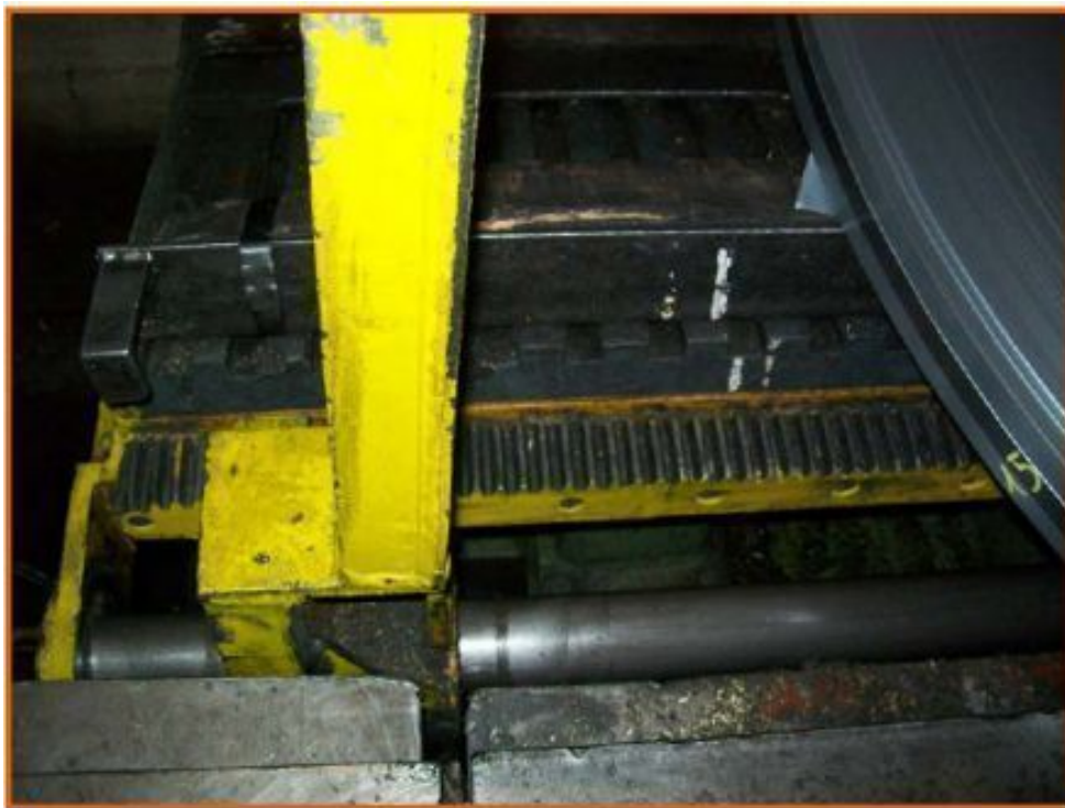
Particolare della culla utilizzata per trasferire i coil dall'aspo alla giostra
