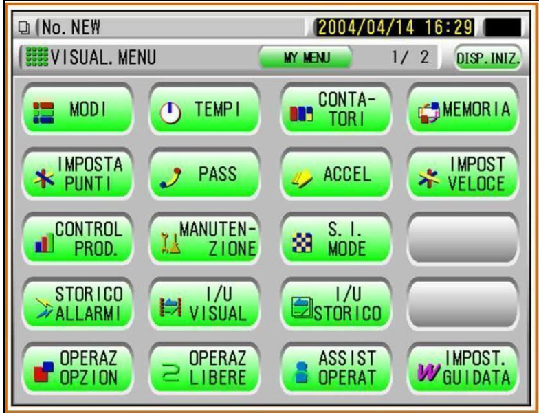
Figura 7: esempio di quadro di comando con pulsantiera digitale contenenti chiare indicazioni della funzione dei pulsanti con colori da norma CEI 44-5.
