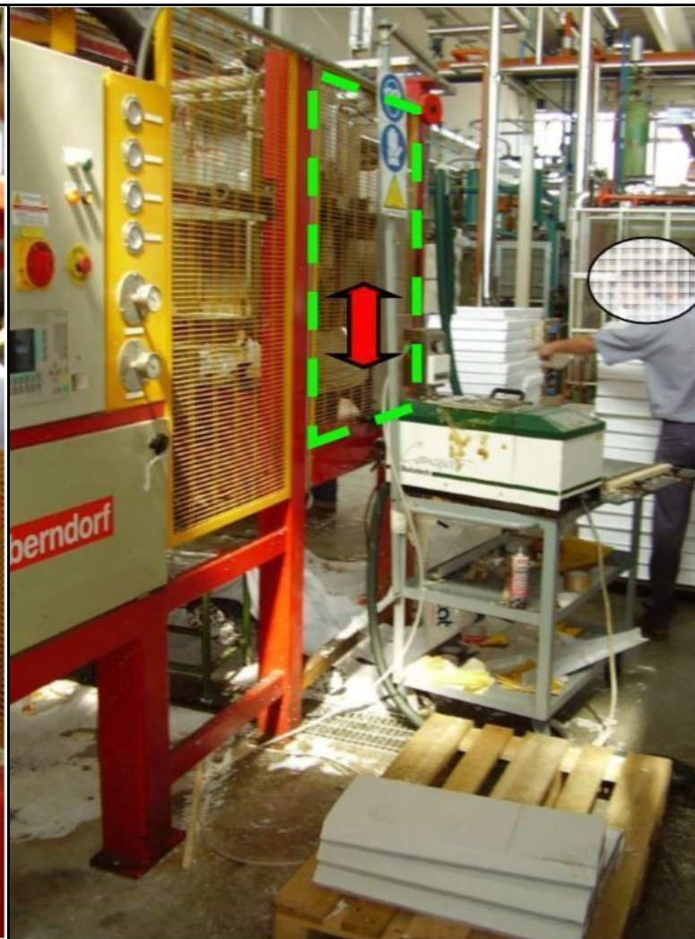
Figura 1b: lato destro dell'impianto accessibile con facilità. Si noti il telaio rosso a supporto delle tubazioni flessibili. L'area tratteggiata in verde rappresenta l'accesso in sicurezza all'area stampo: è costituita da una griglia scorrevole gialla dotata di interruttore di sicurezza per la disattivazione elettrica dell'intera macchina.
