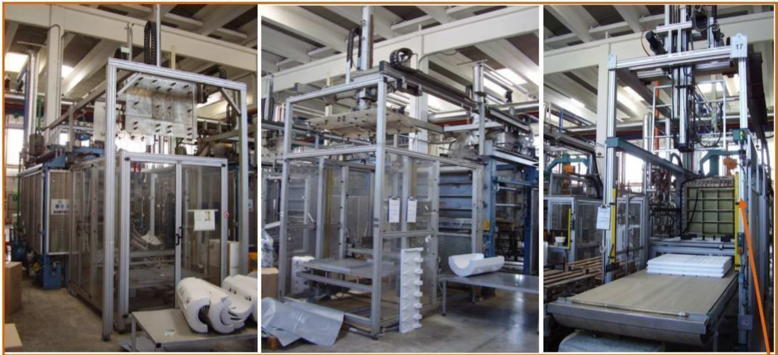
Figura 4: lato scarico pezzi di alcuni impianti presenti in azienda e destinati alla produzione di imballaggi; è possibile osservare il retro di uno dei due stampi.
