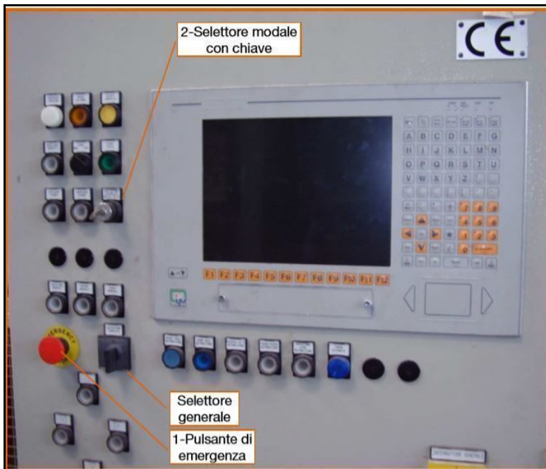
Figura 5: nuovo quadro di comando con pulsantiera digitale contenente indicazioni chiare della funzione del pulsante e aggiunta di altri comandi specifici; in particolare, si nota il pulsante di emergenza (1), il selettore modale con chiave (2), i pulsanti di avvio produzione ed altri specificatamente dedicati con colori da norma CEI 44-5 (colorimetria comandi) e pubblicazione IEC 417 (utilizzo di simboli). I simboli di uso più comune sono riportati nella norma CEI 44-8.
