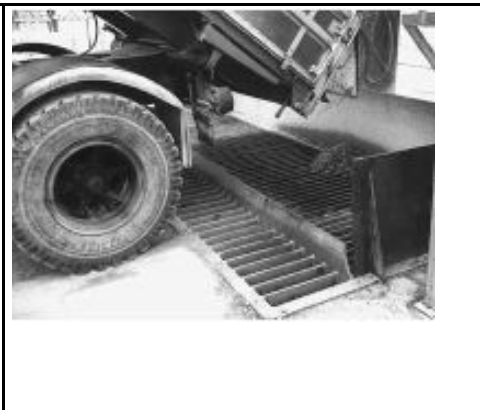
Figura 10: apertura di alimentazione provvista di un grigliato di protezione non destinato al passaggio degli addetti. Tra le sbarre della copertura si possono avere luci della larghezza fino a 80 mm
