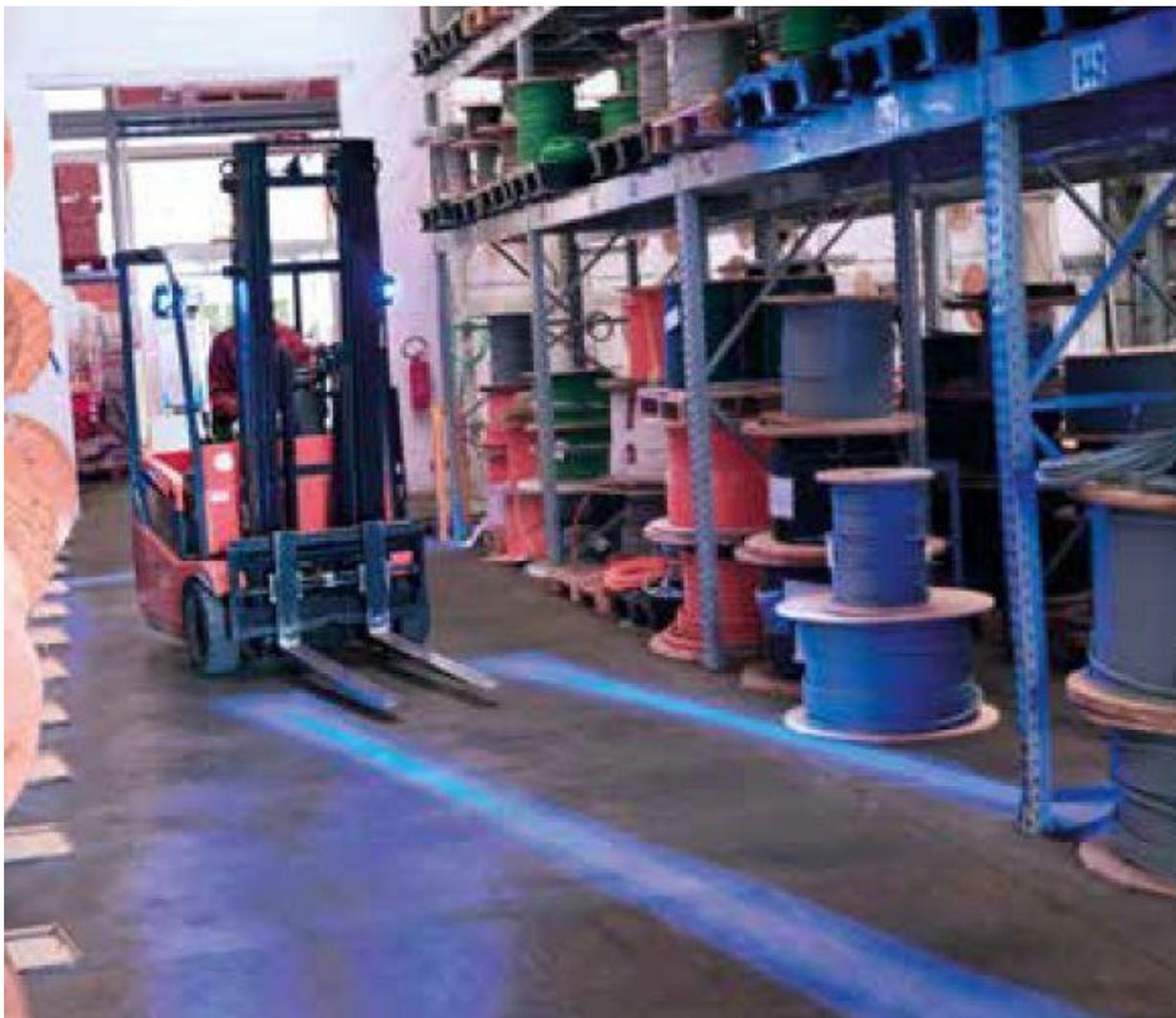
**Sistema di safety lighting per gli incroci:** è uno speciale sistema che permette, attraverso l'illuminazione, di aumentare il livello di sicurezza nelle zone di lavoro: attraverso sensori e ricevitori wifi è possibile accendere e spegnere automaticamente le Safety Bar e/o le Mini e Mid Safe posizionate in prossimità degli incroci.
