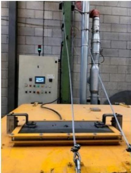
**Foto 4:** apertura controllata di ventilazione
