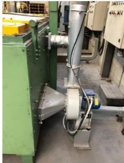
**Foto 5:** sistema di controllo aspirazione
