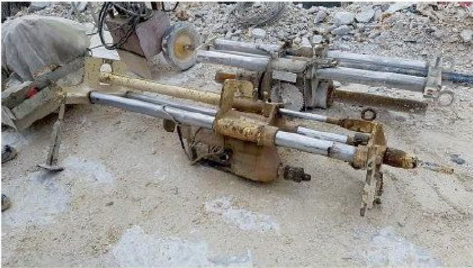
Foto 1 - fotografia rappresentativa di due macchine perforanti per effettuare fori in roccia
