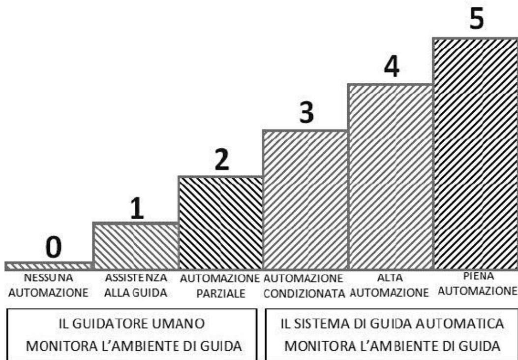
**Figura 1 - Livello di automazione di guida**
