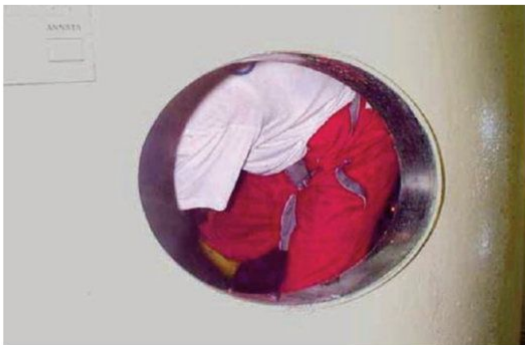
Addetto all' estrazione delle vinacce all'interno del vaso
