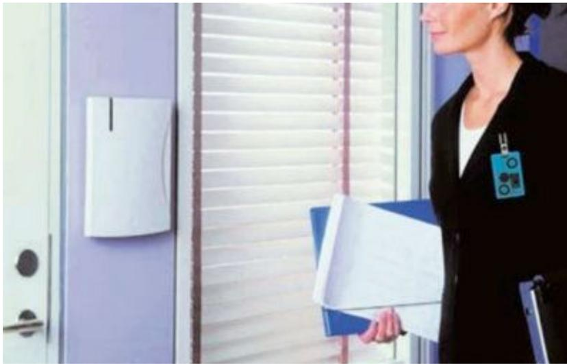
I dispositivi trasmettitori di codici sono facilmente utilizzabili da utenti disabili, ma possono esser utilizzati solo in contesti di bassa sicurezza, perché i messaggi radio possono esser captati e decodificati.
