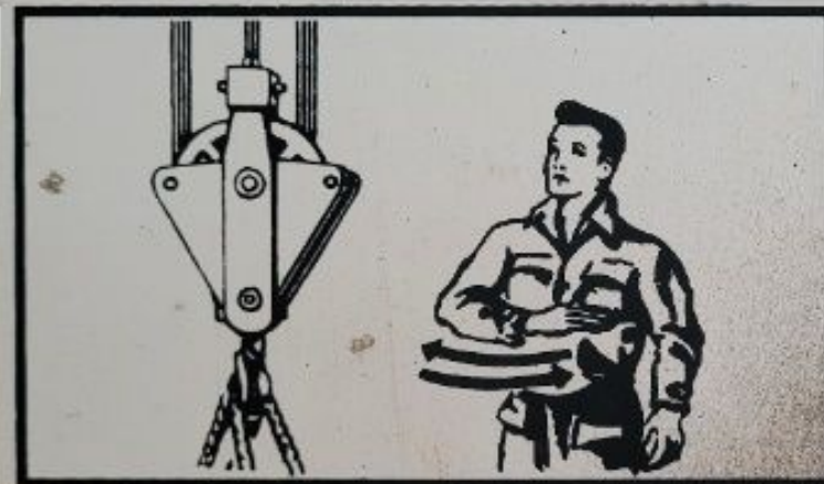
8. - Arresto immediato - Doppio rapido movimento orizzontale del braccio all'altezza del petto.
