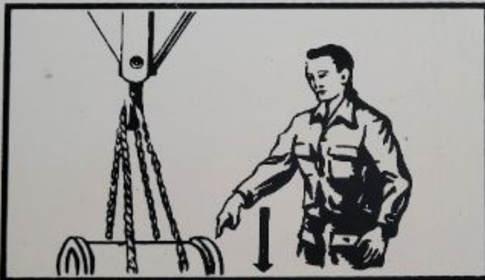
6. - Discesa - Direzione dell'indice e movimento del braccio verso terra.
