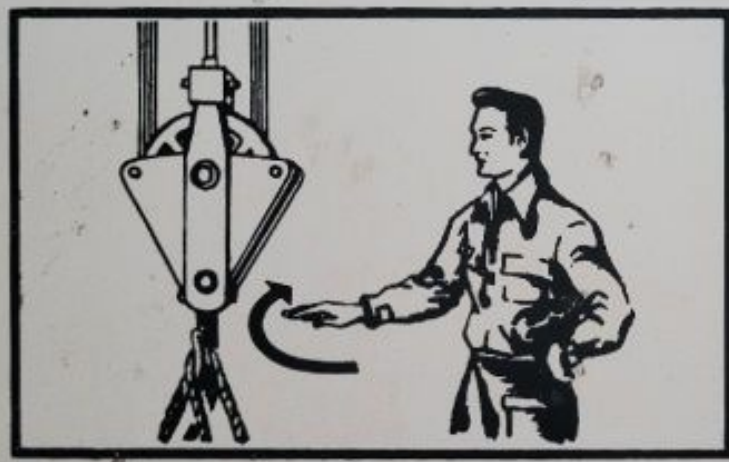
7. - Arresto - Movimento orizzontale del braccio all'altezza del petto.
