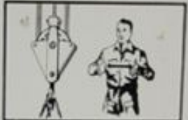
4. - Messa in posto - Movimento ascendente della mano secondo il bisogno.
