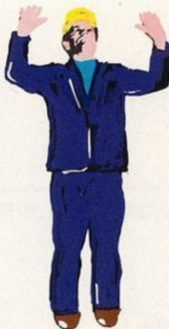
arresto immediato - pericolo
