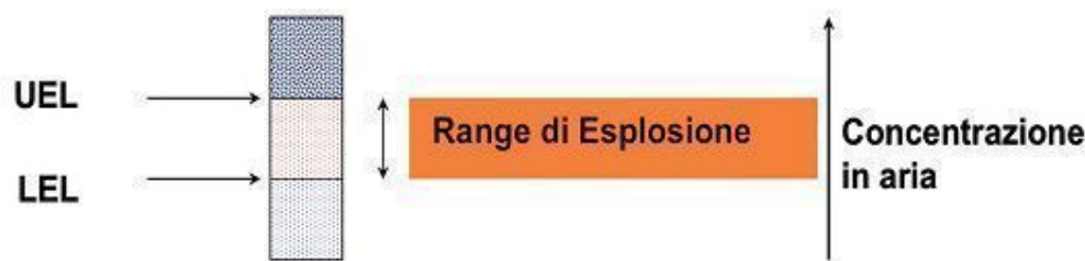
Figura 1.0- Range di esplosione di una sostanza
