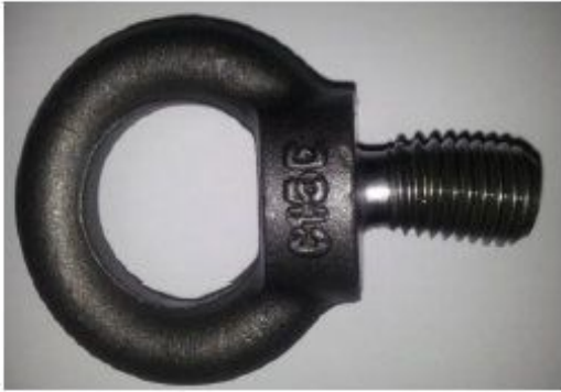
Figura 2 esempio di golfare avente gambo filettato deformato
