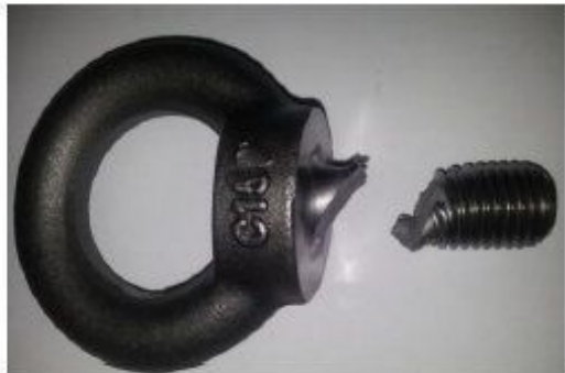
Figura 3 esempio di rottura del gambo filettato di un golfare
