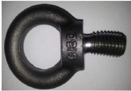
Figura 2 esempio di golfare avente gambo filettato deformato
