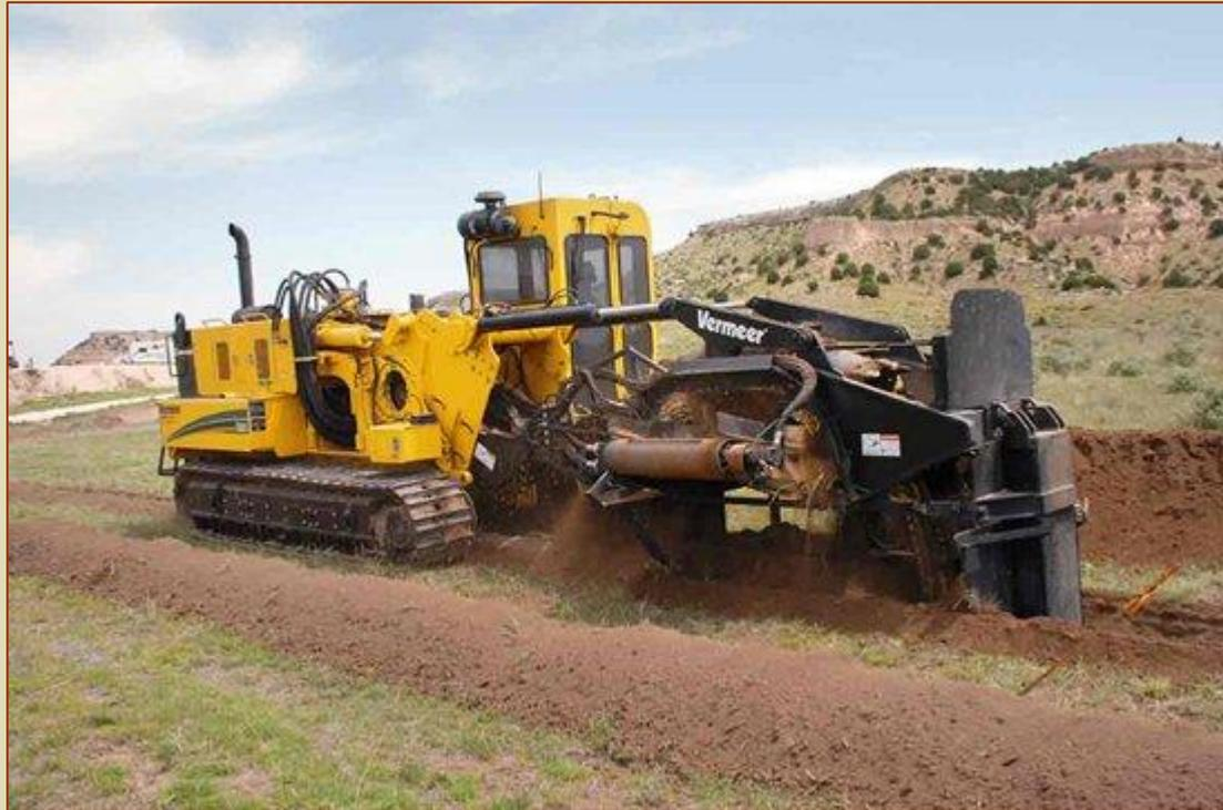
Tali macchine cingolate sono in genere equipaggiate con **bracci** e **catene di scavo** per terreno normale, terreno asfaltato e terreno con sottofondi rocciosi.
