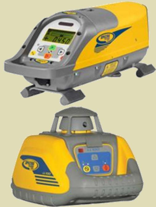
Il **livello a raggi laser** è costituito da una sorgente di un sottile fascio di raggi laser, che ruota su un supporto perfettamente piano, e da un recettore, che se colpito dal fascio di raggi lungo una sottile fessure, emette dei segnali. È impiegato per individuare punti sullo stesso piano.
