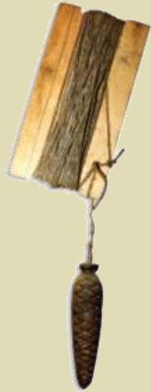
Il *filo a piombo* è lo strumento più esatto per controllare la verticalità di uno spigolo. Lo si usa anche per alzare o abbassare lungo la verticale un punto di riferimento.
