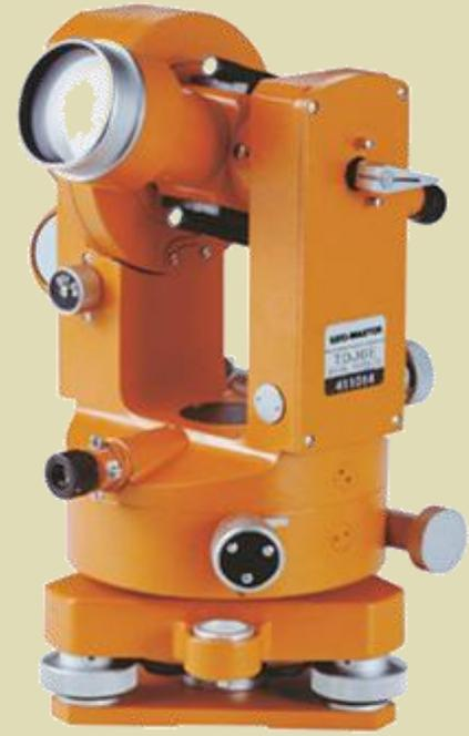
Il **tacheometro** è uno strumento, simile al teodolite, atto alla misurazione sia angolare che metrica di media precisione.
