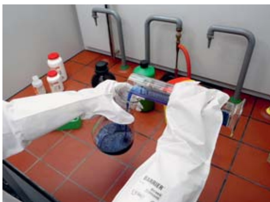
Fig. 13: coloro che sul lavoro vengono a contatto con sostanze pericolose o riassorbibili dalla pelle devono utilizzare speciali guanti di protezione resistenti alle aggressioni chimiche.
