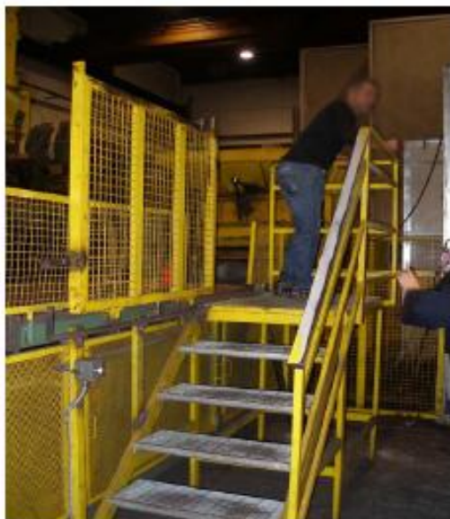
Scala fissa per l'accesso alla rulliera di trasporto dei cestoni porta carico
