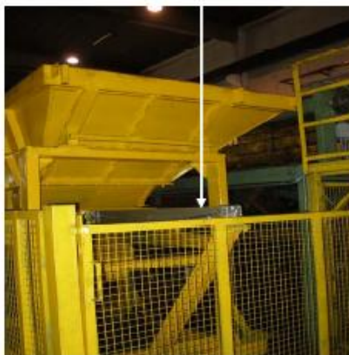
pistone del nuovo sistema di scarico pezzi della tramoggia
