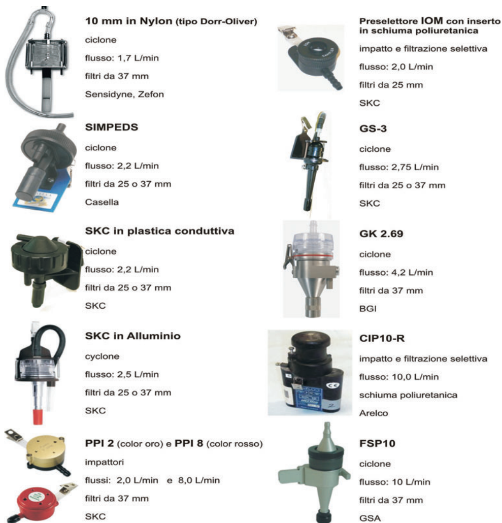
Figura 3.1. - Tipologia, flussi di aspirazione, substrati di raccolta del campione e produttori dei selettori personali per il campionamento delle polveri respirabili 16 .
