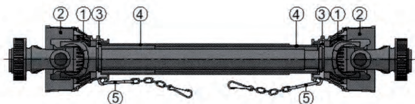
Legenda: 1 cuffia; 2 cuffia del giunto grandangolare; 3 ghiera di collegamento; 4 tubo telescopico; 5 catenella di ritenuta
