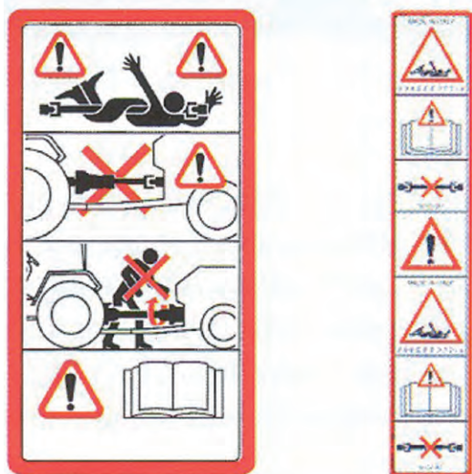
Esempio di pittogrammi di sicurezza
