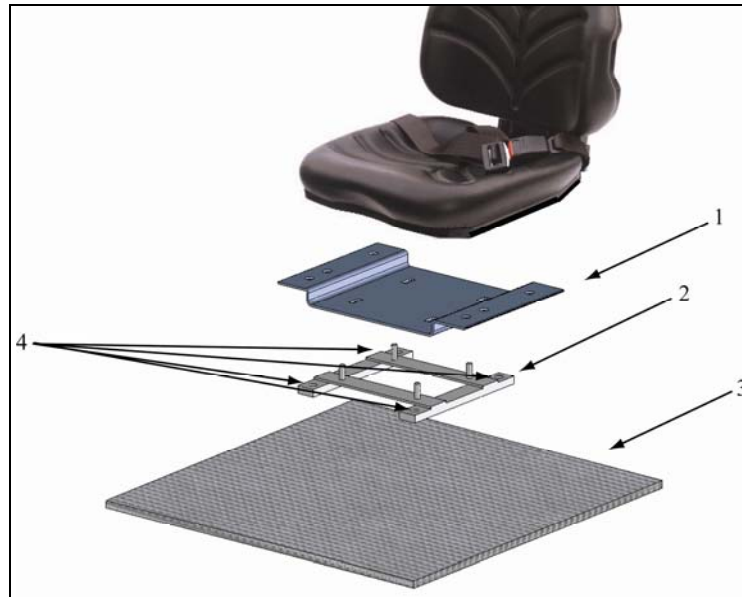
Figura 11 – Esempio di staffa a quattro punti di attacco (1 piastra del nuovo sedile, 2 staffa di collegamento, 3 struttura portante del trattore, 4 punti attacco della staffa alla struttura portante della motoagricola)
