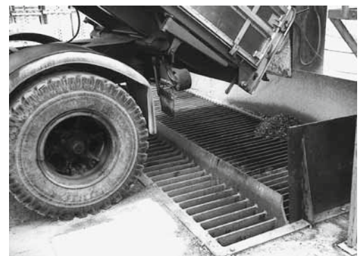
Figura 10: apertura di alimentazione provvista di un grigliato di protezione non destinato al passaggio degli addetti. Tra le sbarre della copertura si possono avere luci della larghezza fino a 80 mm al massimo. Le maglie della griglia possono avere un'ampiezza massima di 150 x 150 mm.
